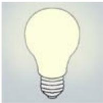
Incandescente - Gera luz com base no aquecimento de um filamento de tungstênio e conta com diferentes formatos de bulbo. Reproduz as cores com total fidelidade, porém consome muita energia e perde a eficiência com o tempo.
