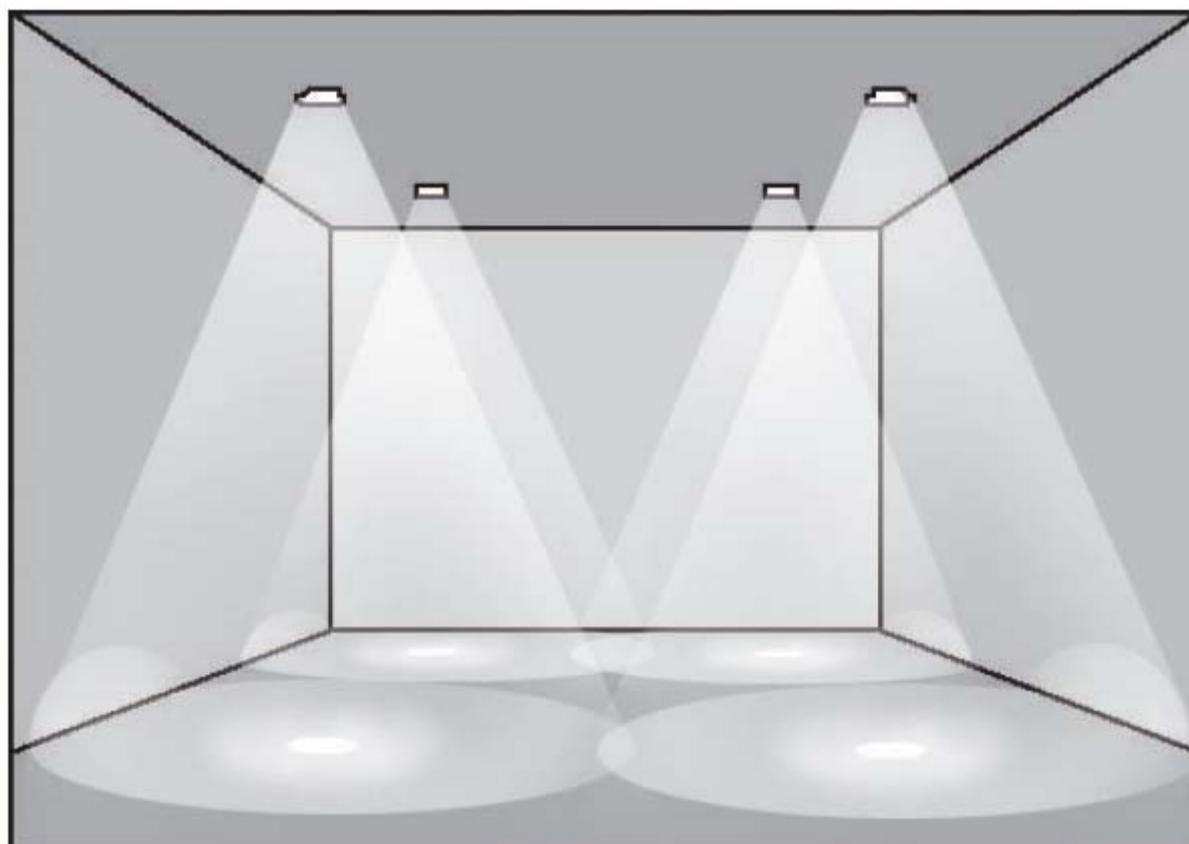
Luz para baixo (downlight) - Lâmpadas halógenas de foco fechado no teto são direcionadas para os elementos que se quer destacar. Para acertar o alvo, deve-se fazer um cálculo geométrico levando em conta o pé-direito e o ângulo do fecho de luz da lâmpada.
