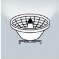
Halógena AR - O fecho definido (com ângulos entre 4 e 24 graus) torna esta lâmpada ideal para destacar objetos especiais e obras de arte. Um contra-refletor envolve a cápsula e reduz o ofuscamento.
